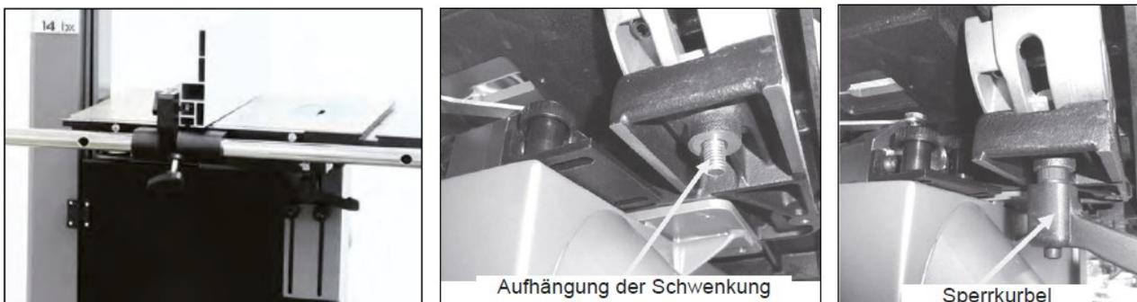
Um den Arbeitstisch in die Aufhängung zu befestigen, sind zwei Sperrkurbeln zu befestigen. Die Ausrichtung des Arbeitstisches mit dem Sägeband wird weiter in diesem Handbuch beschrieben.
