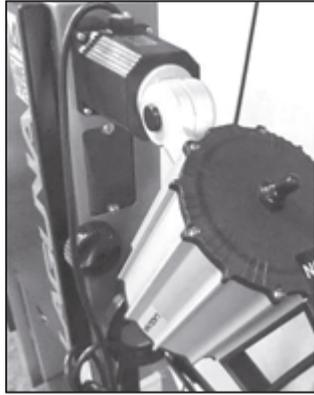
Das Licht wird am Oberteil der Bandsäge gemäß Abbildung montiert. Das Licht wird mit einem Anschlussstecker geliefert. Das Kabel ist so zu legen, dass es sich auf keinen Fall in der Nähe des Sägebands oder der Schranktür befindet.
