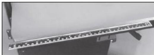
Den Maßstab an den Arbeitstisch mit mitgelieferten Schrauben befestigen. Die Schrauben nicht ganz festziehen, die Position des Lineals muss noch gegenüber dem Sägeband angepasst werden (siehe weiter in diesem Handbuch).
