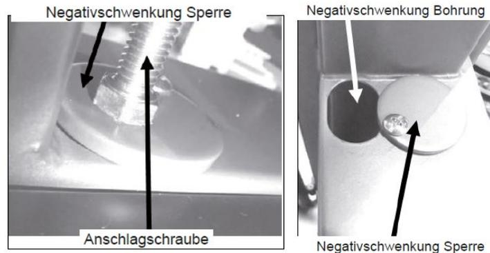
Der Arbeitstisch ist mit einer Anschlagschraube ausgestattet, um den Arbeitstisch nach Schwenkung schnell auszurichten. Die Anschlagschraube berührt die Negativschwenkung Sperre. Nach der Lösung der Negativschwenkung Sperre kann der Arbeitstisch bis in -7 Grad geschwenkt werden.
