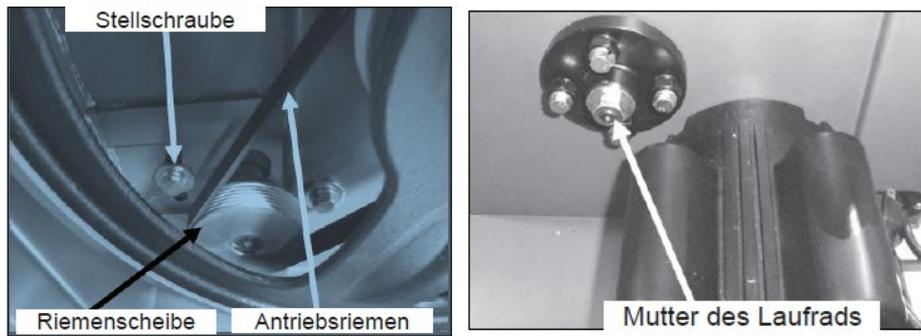
Um den Antriebsriemen auszutauschen, muss das untere Laufrad entfernt werden.
