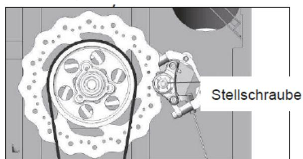
Das Lösen des Bremspedals wird mit dem hinteren Drehknopf eingestellt (Drehen im Uhrzeigersinn). Zur Einstellung vorne die Schraube (mit Sechskantschlüssel) im Uhrzeigersinn drehen.
