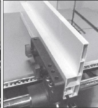
Der Anschlaghalter und der Anschlag sind über den Arbeitstisch mit einer Nylonschraube angehoben. Diese Schraube schützt die Tischoberfläche vor Kratzern. Die Schraube ist einstellbar.
